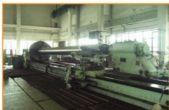
Sústruženie SR2000 10000/ø1600/ø2000
