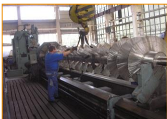
Sústruženie SRM125/7000 10000/ø1010
