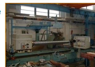
Dynamické vyvažovanie SCHENK 10000/ø2100/7t
